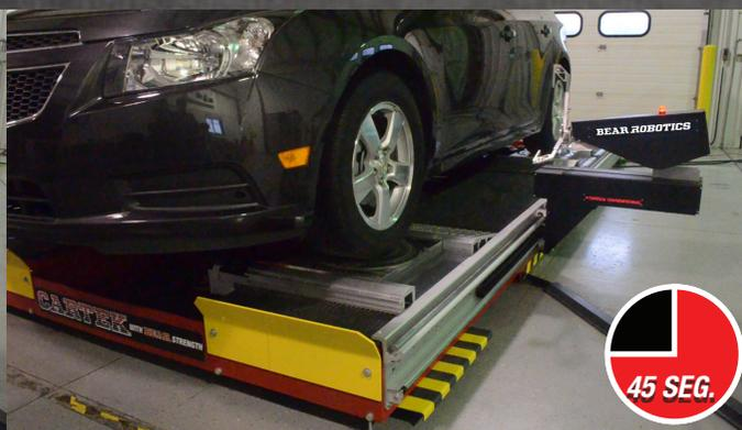
Los Robots se desplazan sobre rieles de aluminio tocando rápidamente las ruedas posteriores y obteniendo lecturas precisas.
