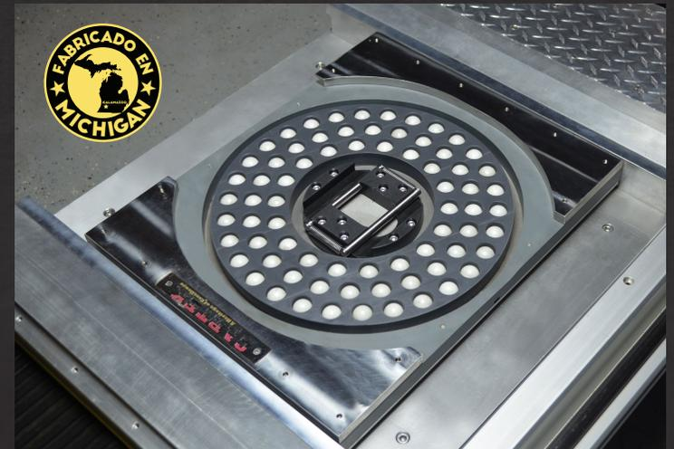
El conjunto del plato de giro está construido con materiales no corrosivos incluyendo Acero Inoxidable, Plástico ABS, Aluminio y Nylon, y es muy sencillo de desarmar y limpiar. Sus 72 esferas de nylon de alto impacto proveen suaves movimientos en todas las direcciones.
